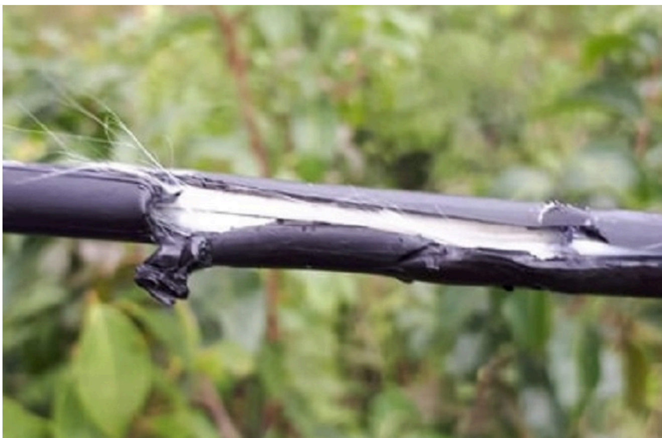
Cabo fibra ótica sabotado (Foto: Divulgação WSP)
